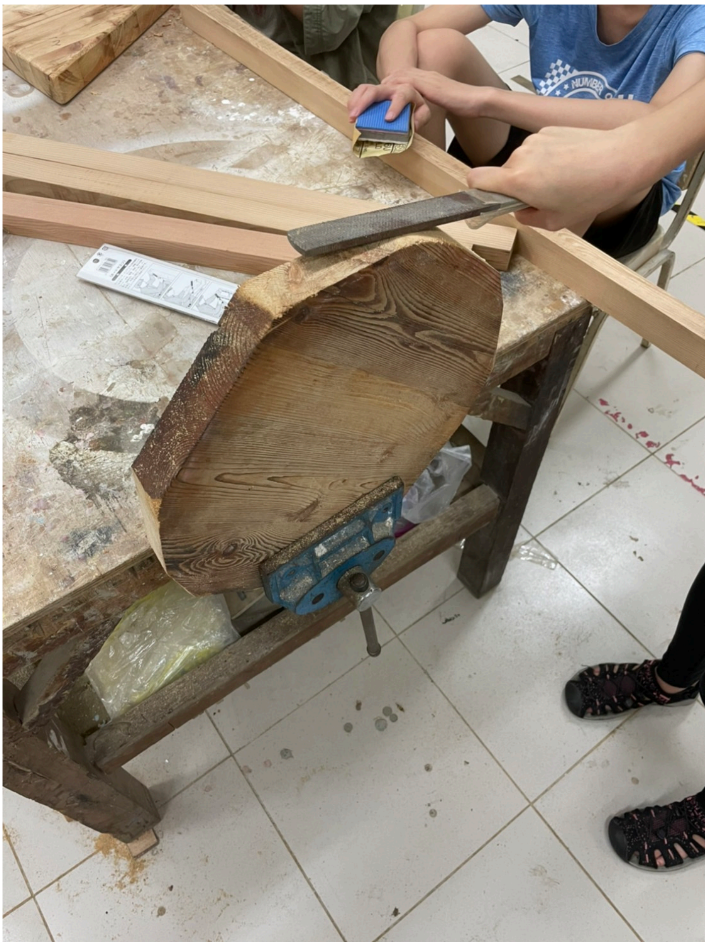
照片十四 椅面修邊：利用大型銼刀進行椅面邊緣修整
