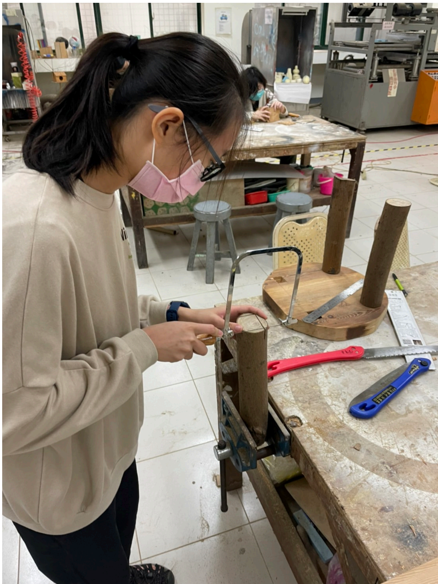
照片六 椅腳樺頭製作：先用線鋸鋸出樺頭的基準線，再換手鋸鋸出樺頭
