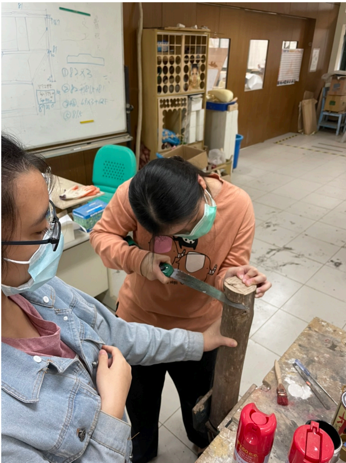
照片八 桌腳樺頭製作：利用手鋸切出樺頭的高度
