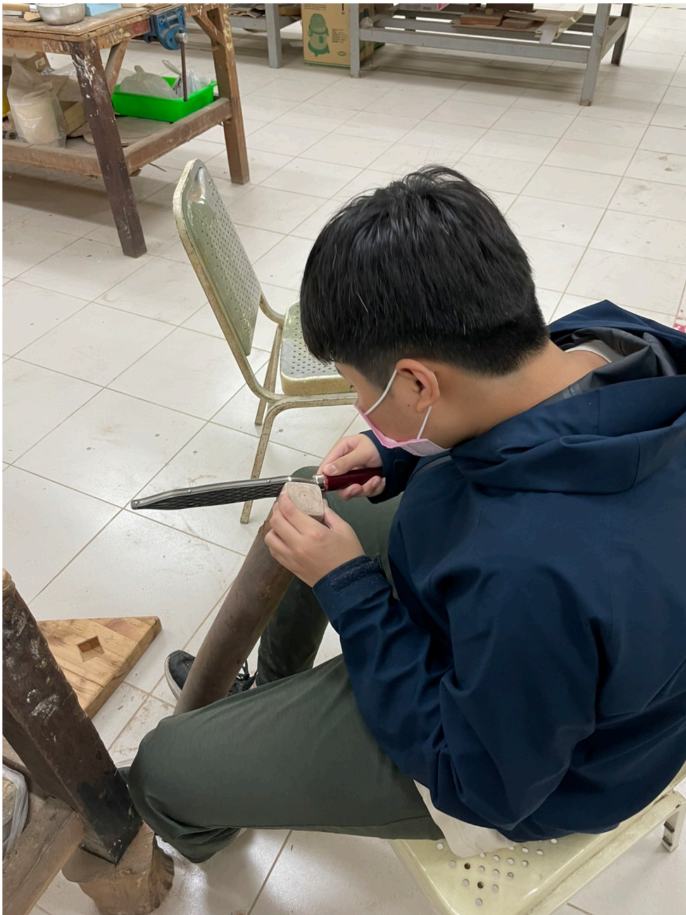
照片十一 桌腳樺頭製作：利用大型挫刀進行樺頭細部修整
