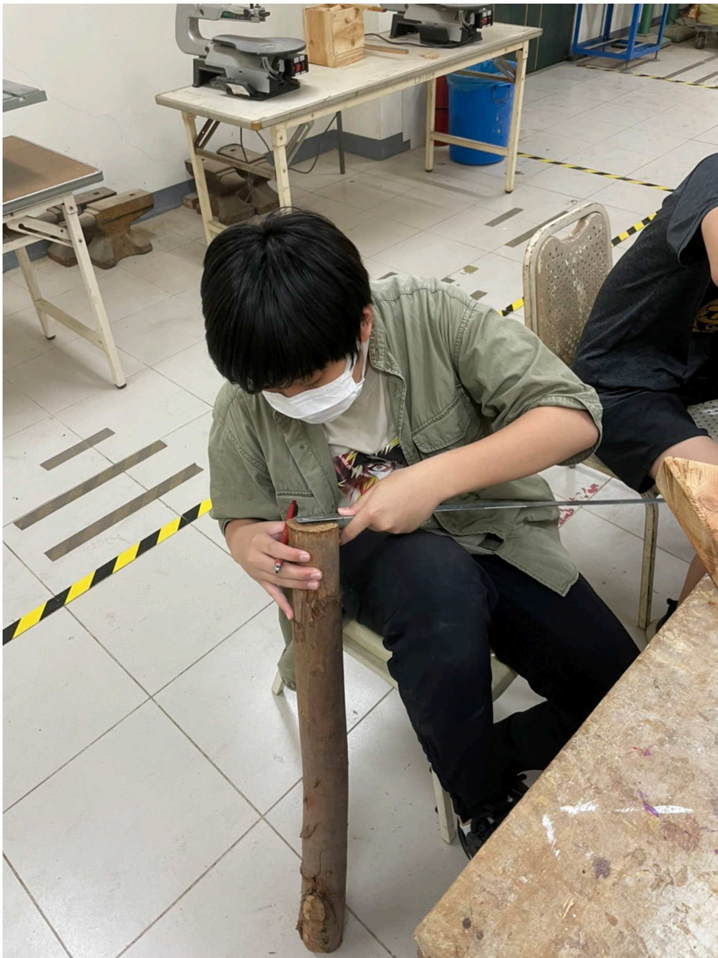
照片十二 桌腳樺頭前置作業：先畫出要鋸切的樺頭長寬高
