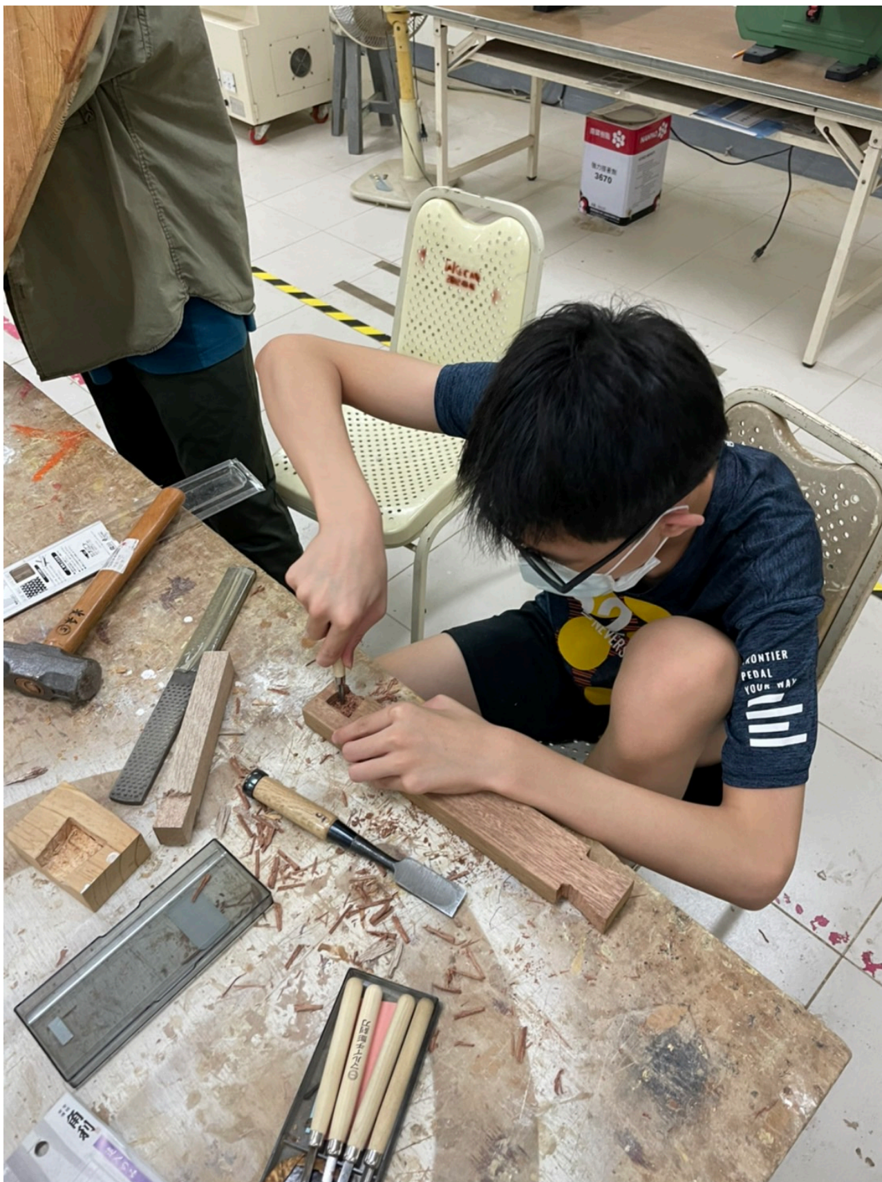
照片二 榫孔練習：利用小型平面鑿刀進行鳩尾榫孔底部修整
