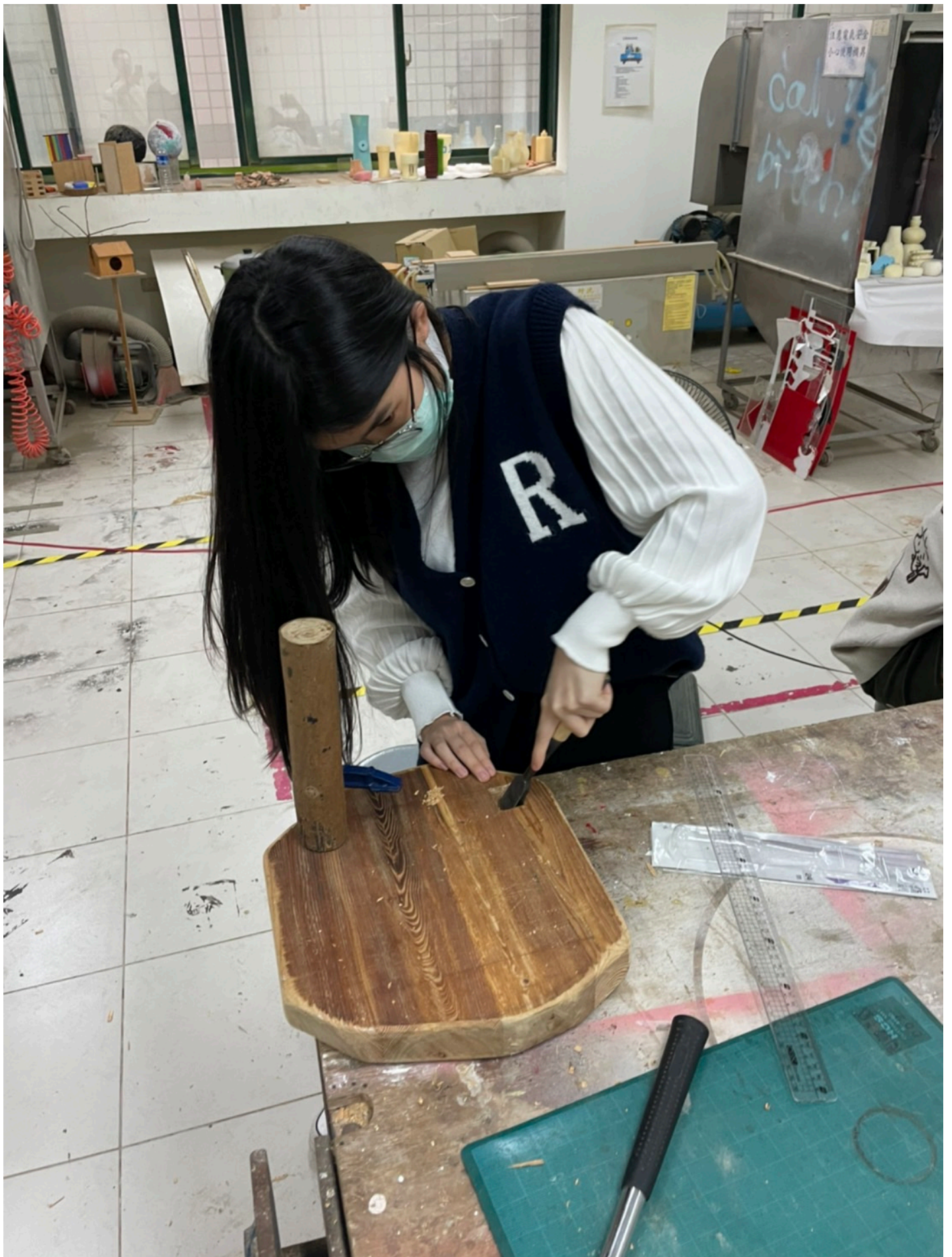
照片五 椅面榫孔製作：利用鑿刀進行榫孔底部修整
