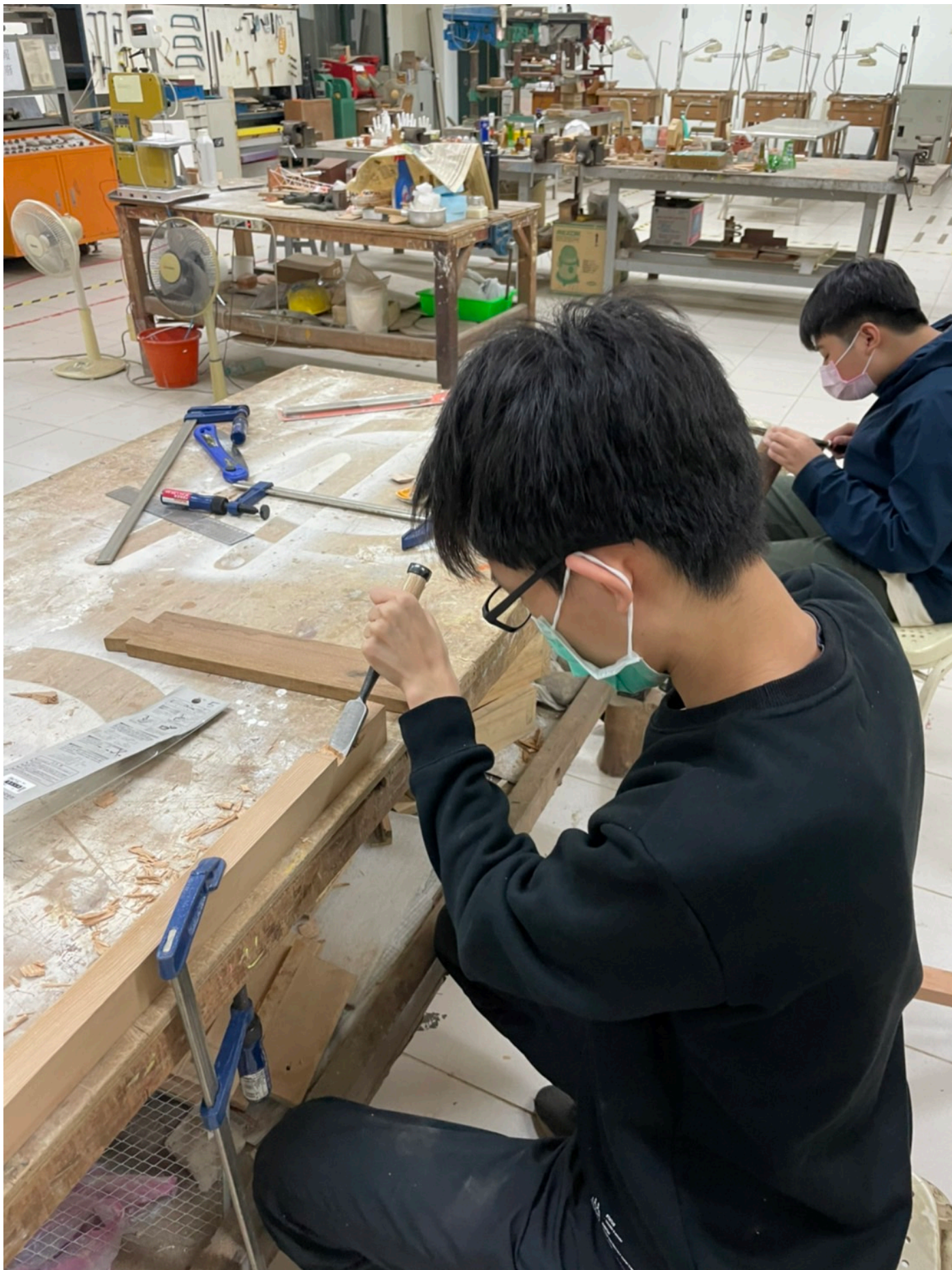
照片七 躺椅後腿鳩尾榫孔製作：打鑿鳩尾孔
