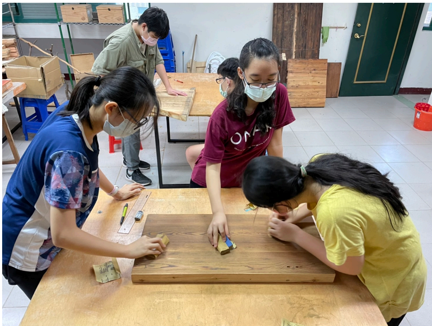
照片十三 桌面修整：團隊合作利用砂紙進行桌面打磨修整
