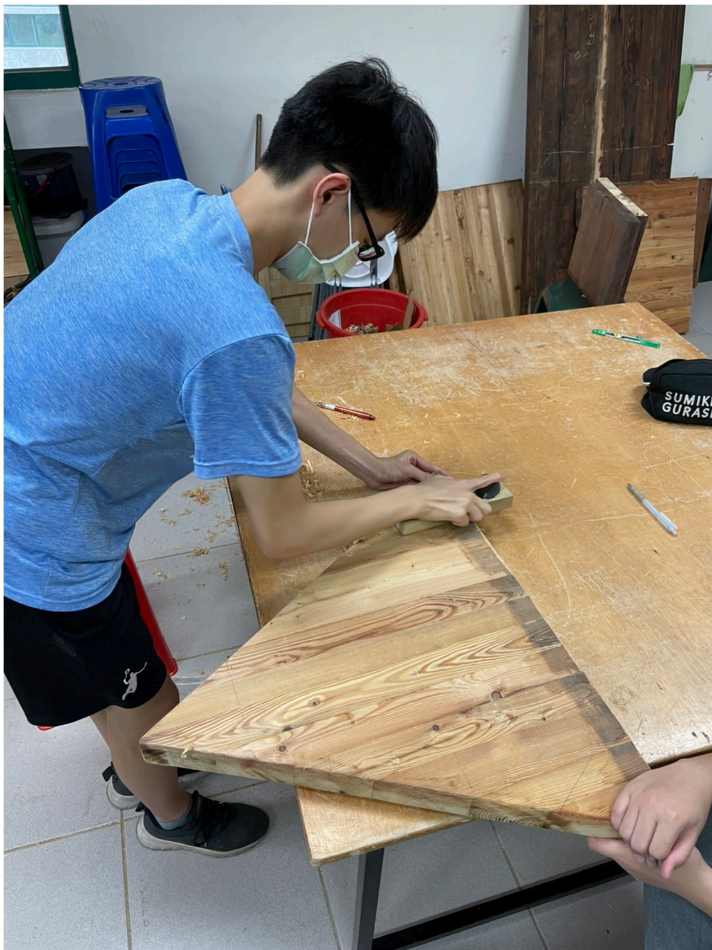
照片十五 桌面修整：利用刨刀進行桌面刨平修整，確保桌面的平整
